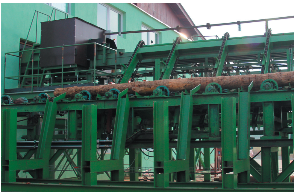
Obr. 4: Podávání kmenů - optické měřicí zařízení je v budce na vstupu do automatické linky
