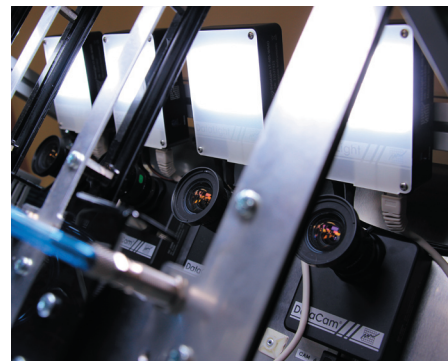
Obr. 4: Osvětlovací jednotky DataLight v blízkosti kamer
