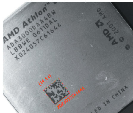
Obr. 2: Identifikace obrazce datamatrix kódu
