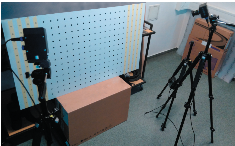
Obr. 1: Testování pohledů jednotlivými kamerami na kalibrační obrazec umístěný ve vztažné rovině.
