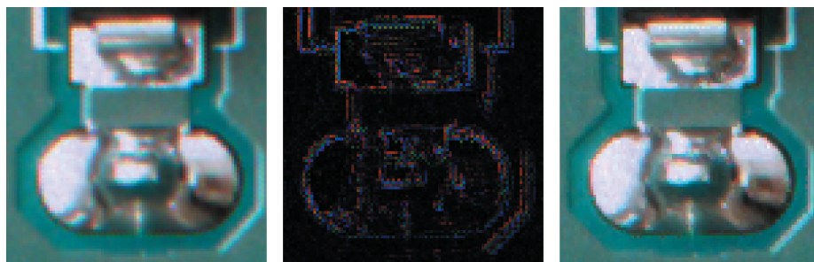
Obr. 3: Rozdílový obraz mezi bilineární a adaptivní interpolací
