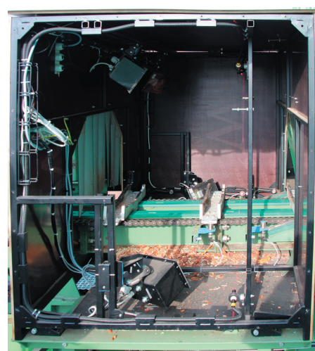
Obr. 10: Měřicí systém se čtyřmi kamerami a laserovými projektory čar. Provedení kamer je přizpůsobené pro vysokou klimatickou i mechanickou odolnost
