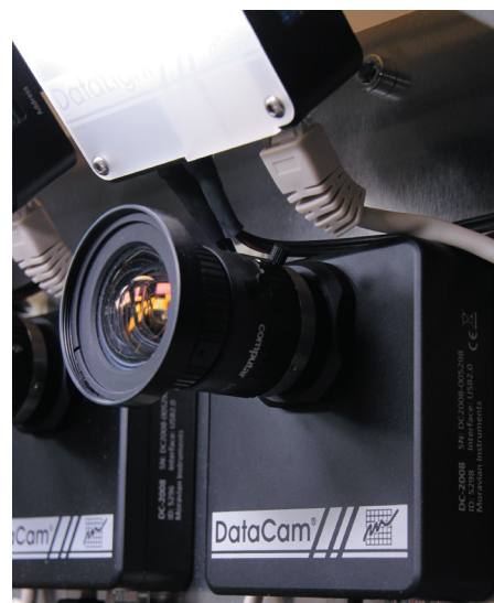
Obr. 7: Jsou použity pevné objektivy s krátkou ohniskovou vzdáleností
