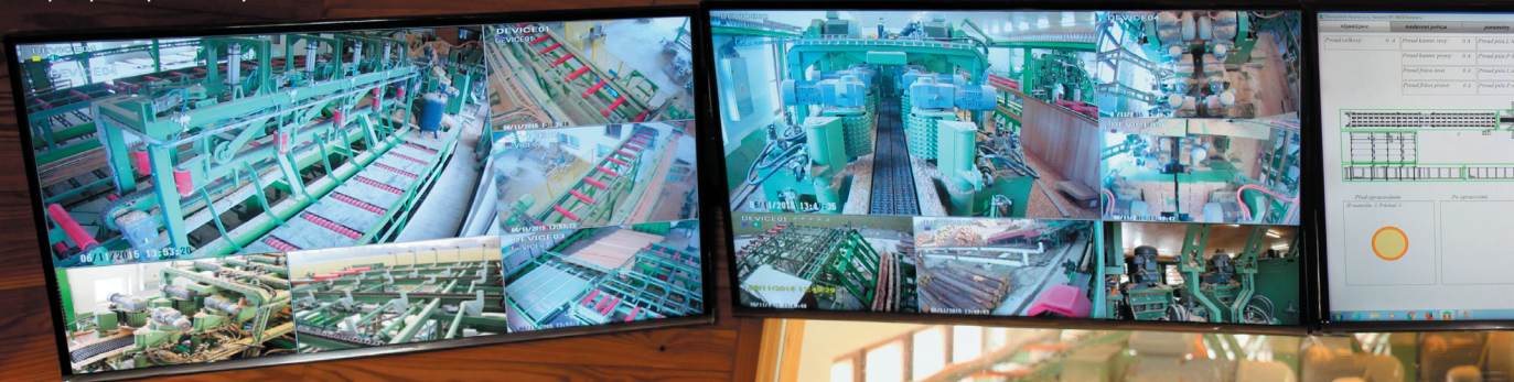
Obr. 6: Data z kalibrovaných kamer laserových profilometrů pro předzpracovaný hranol
