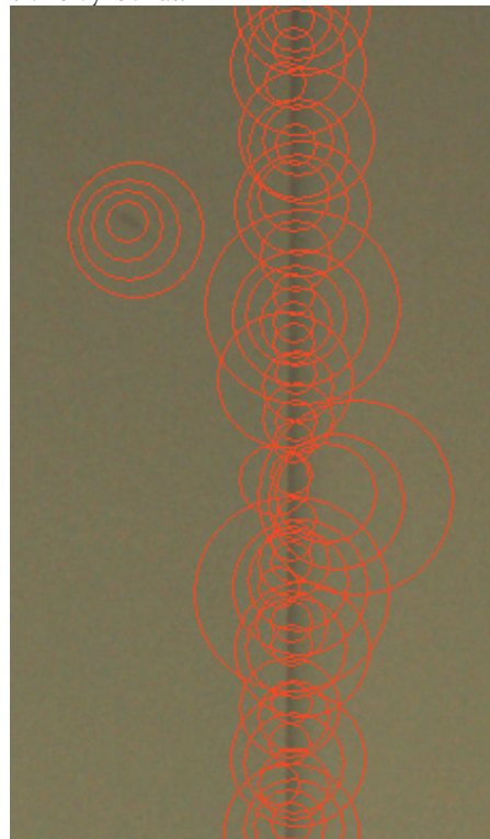
Obr. 5: Multiměřítková detekce povrchových defektů
